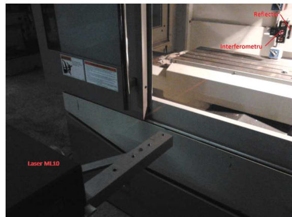
Fig. 4. Installing the Y axis laser.
